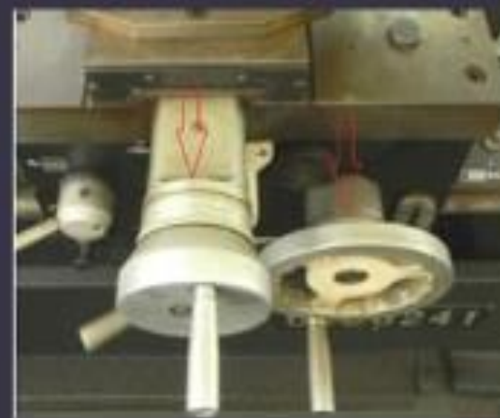
Gambar 9 Nonius pada roda pemutar eretan memanjang dan melintang
