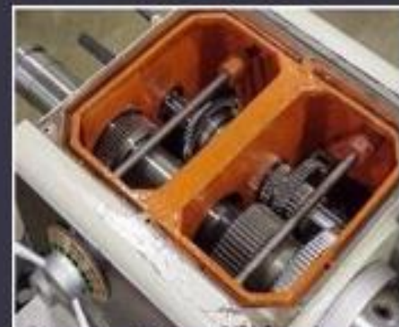
Gambar 4 Gear box pada kepala tetap
