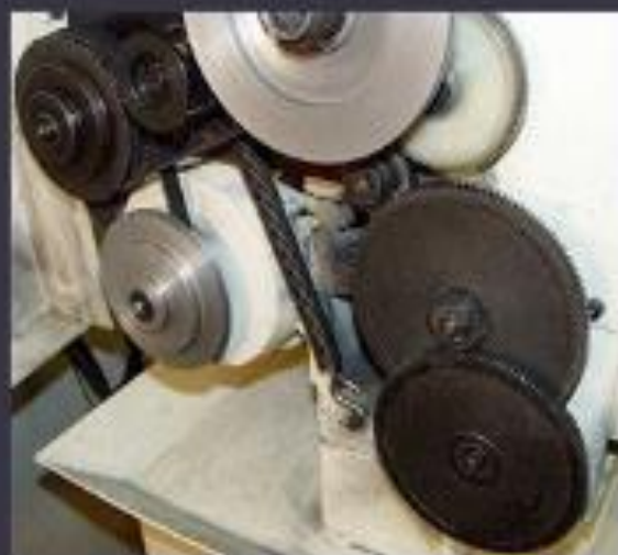
Gambar 3 Sistem penggerak dan pengatur putaran mesin/ kecepatan pemakanan dengan roda pully dan sabuk V
